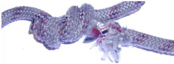
Ilustración 1.: Roturas de fibra en el nudo
