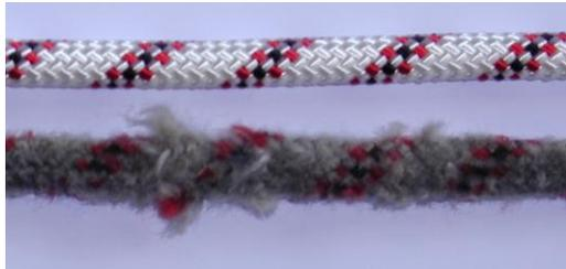
Ilustración 2: fuerte abrasión de la cuerda, desgaste con hinchazón de cuer
