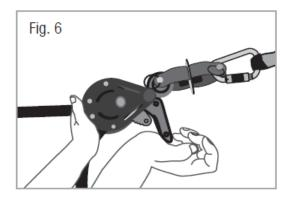
La línea de vida horizontal está diseñada para usarse en un intervalo de hasta 25 metros, , la flecha se indica en la tabla a continuación.
