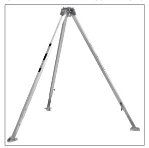
Carga máxima : 2 personas o 500 kg Peso en vacío aprox.: 14,5 kg Altura erguido: 1,35-2,35 m
