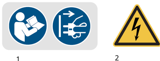
Figura 1-1: Marcas de seguridad - 1 Símbolo obligatorio: seguir las instrucciones, desconectar el enchufe de red I 2 Advertencia de tensión eléctrica
