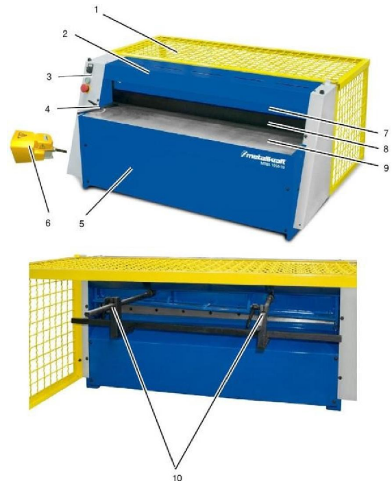
Fig. 4: Cizalla de guillotina para chapas motorizada- descripción del dispositivo
