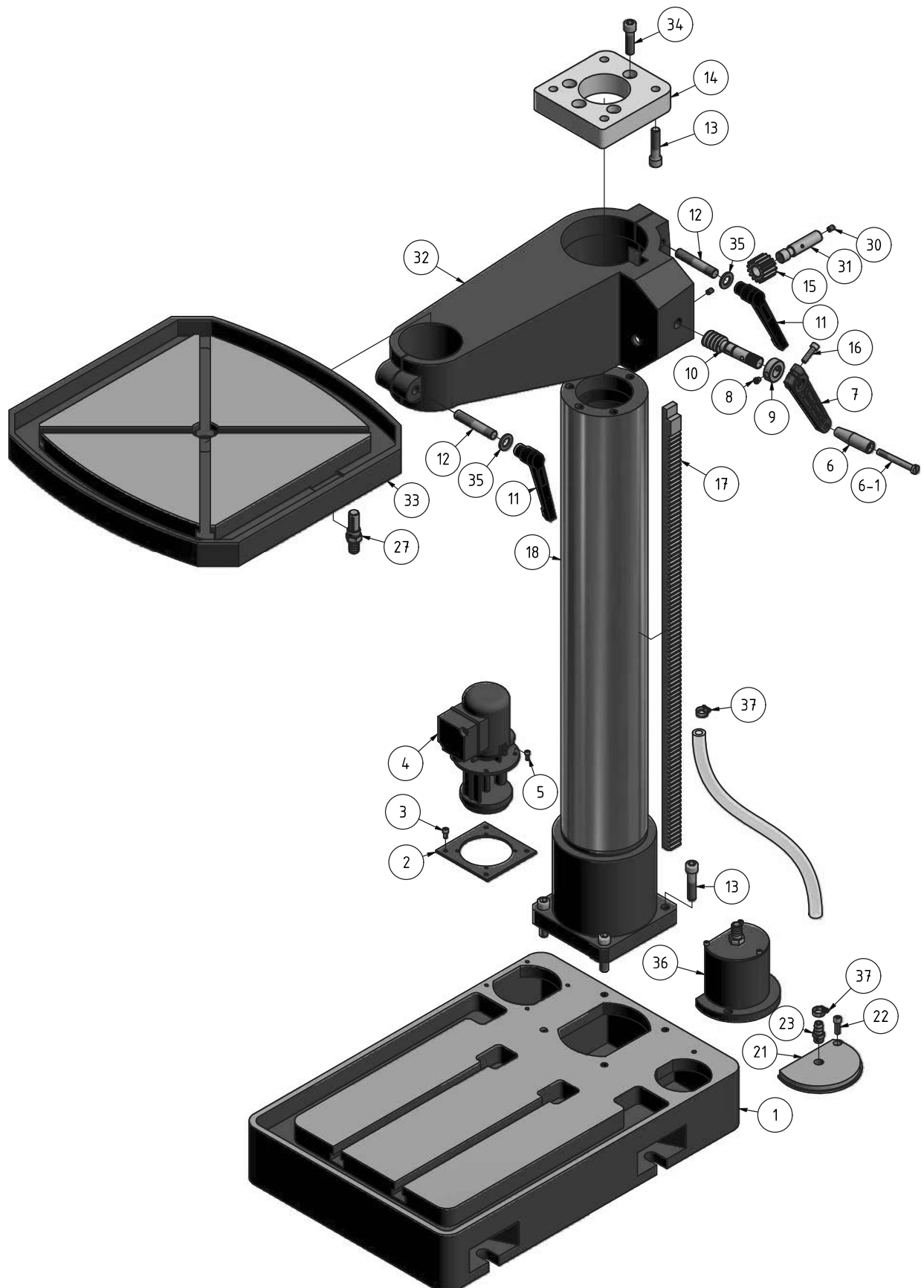
Img.1-11: Säule und Bohrtisch - Column and drilling table
