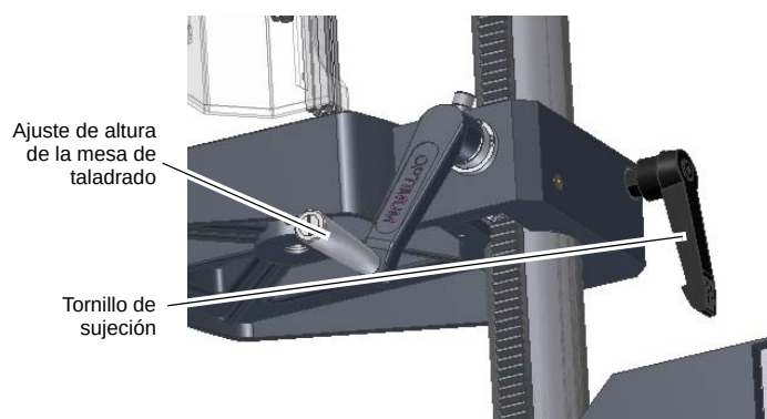
Fig.4-9: Reajuste de la altura de la mesa por medio de manivela y barra dentada.
