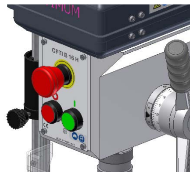
Fig.1-1: Paro de emergencia B16H
