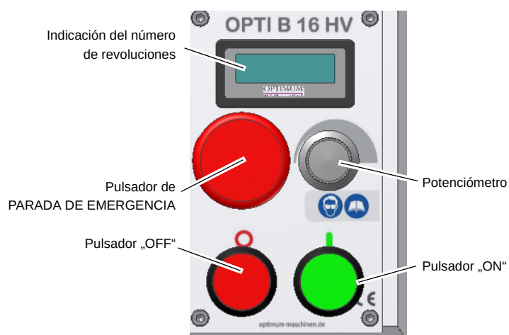
Fig.4-3: Elementos de mando en el panel de control B16H Vario
