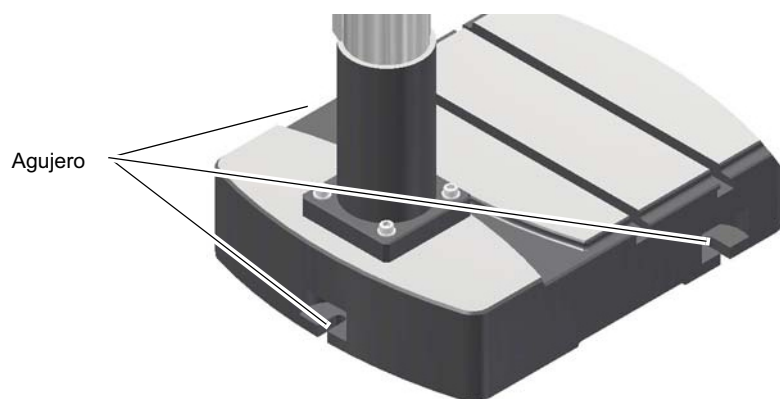
Img.3-1: Agujeros de anclaje en la DH 28 GS
