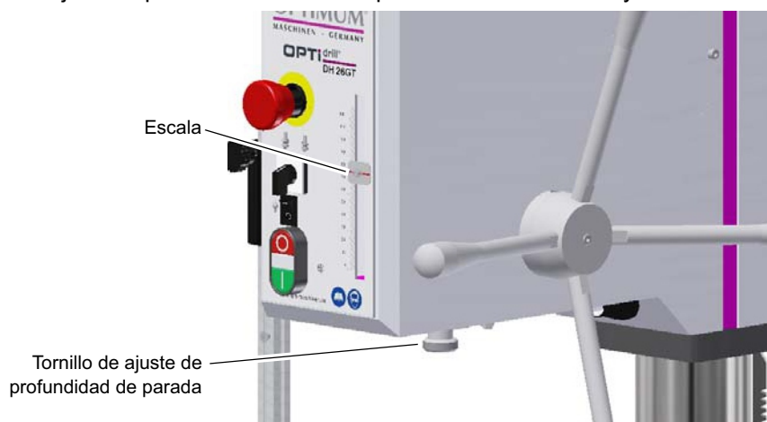
Img.4-4: Profundidad de parada de taladro
