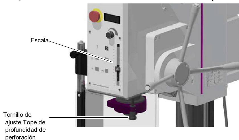
Img.4-12: Tope de profundidad de perforación
