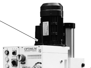
Img.1-1: Cubierta protectora
