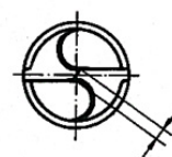
Longitud del borde del cincel 10% de la broca - Ø
