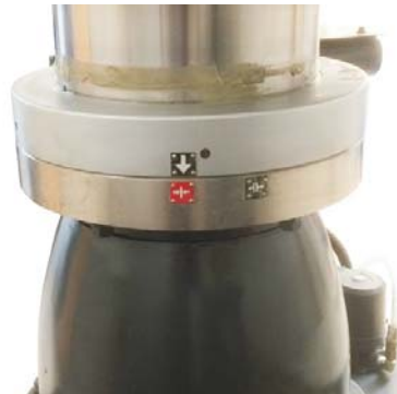
Img.4-4: Marcado estado de bloqueo
