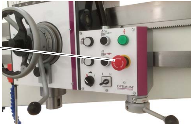
Img.1-1: PARADA DE EMERGENCIA
