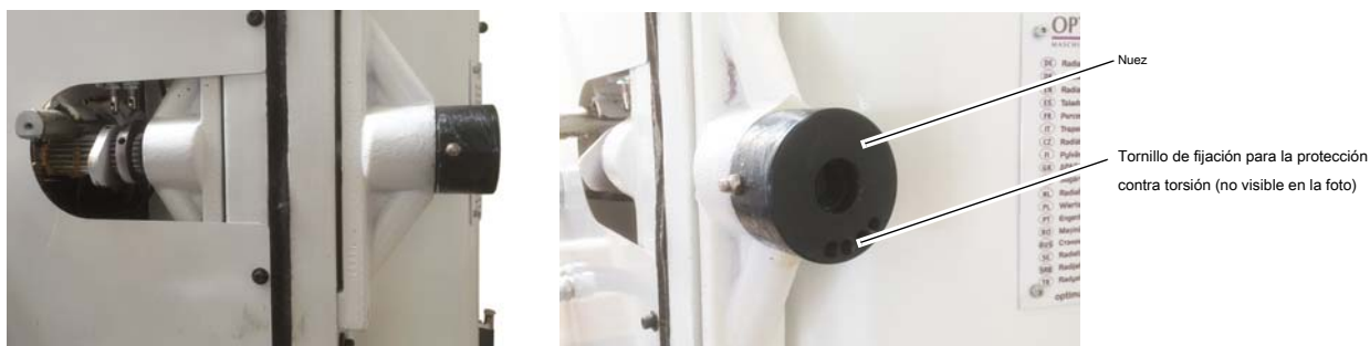
Img.5-2: Fijación de voladizo
