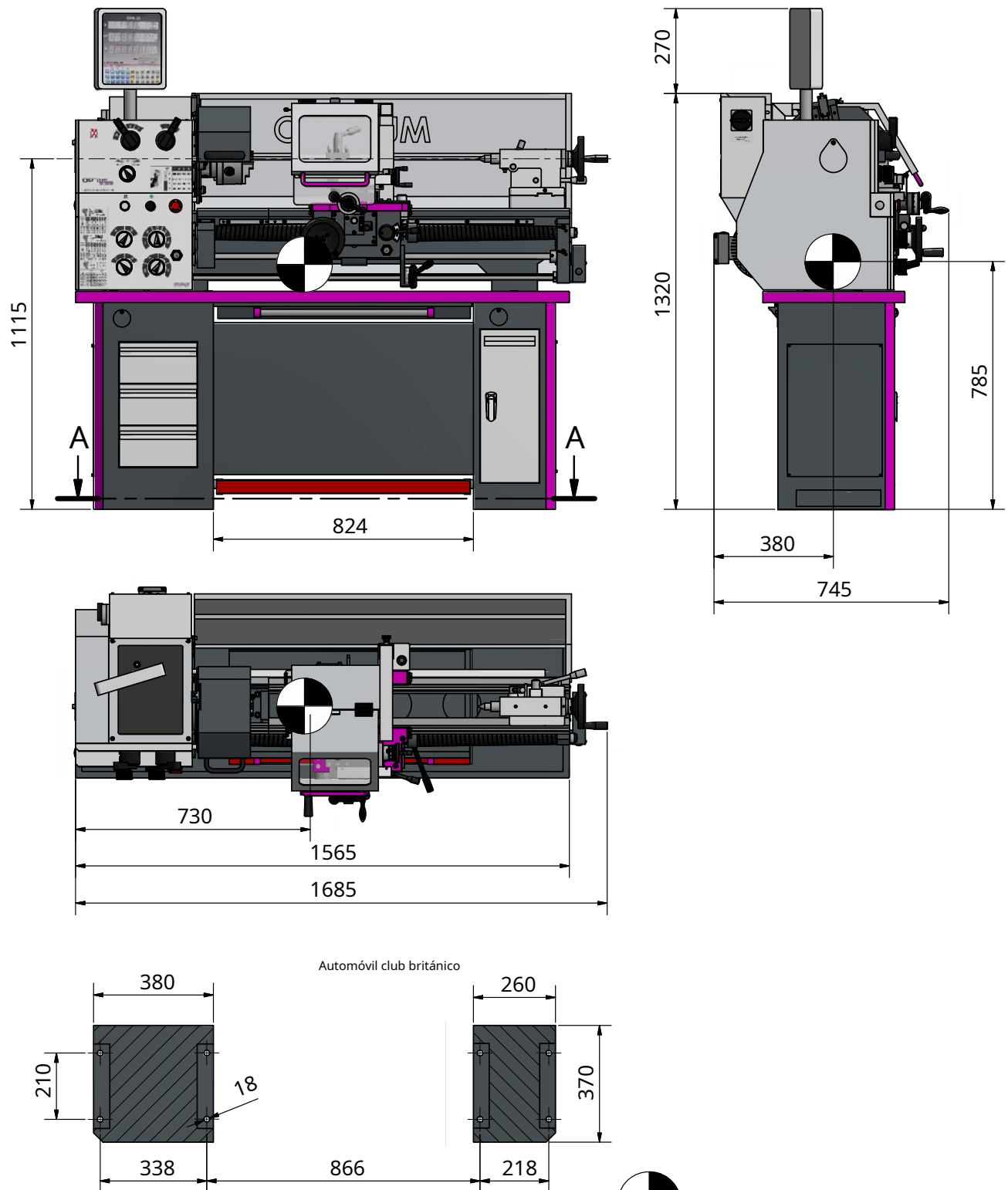
Img.2-1: Dimensiones, plano de instalación
