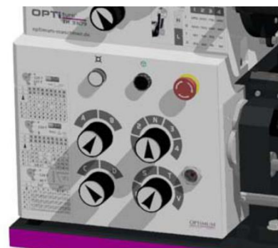
Img.4-1: Entrada interruptor selector
