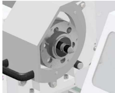
Img.4-8: Punto de centrado con manguito reductor
