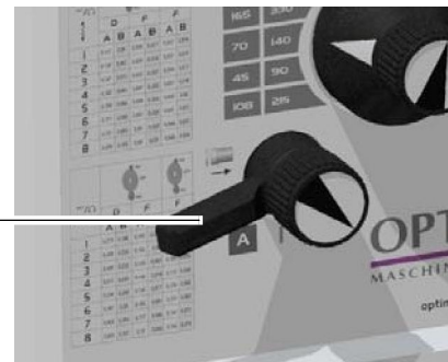
Img.4-2: Dirección de avance palanca de selección
