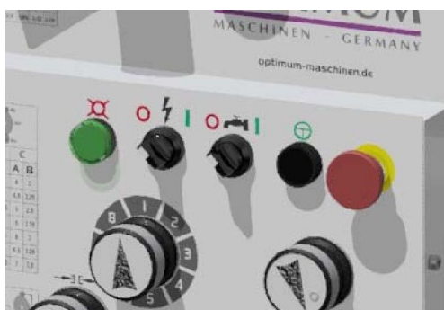
Panel de control en el cabezal
