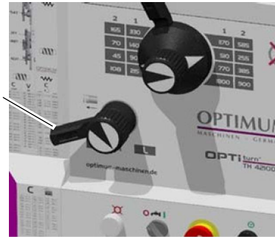
Img.4-5: Sentido de giro varilla de avance
