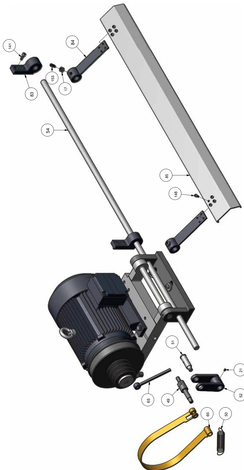
7-25: Spindelbremse - ruptura husillo
