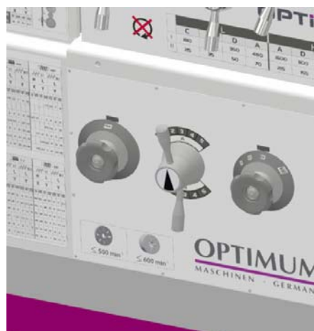
Imagen 4-2: Palanca de selección de alimentación
