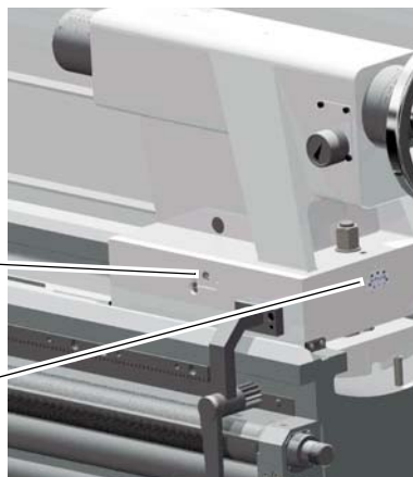
Img.4-15: Ajuste transversal del contrapunto
