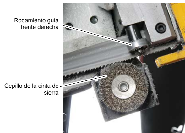
Fig.3-14: Guía de cinta de sierra derecha
