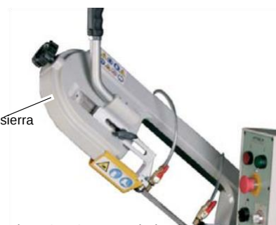
Fig.1-3: Carcasa de la sierra con cubierta de protección
