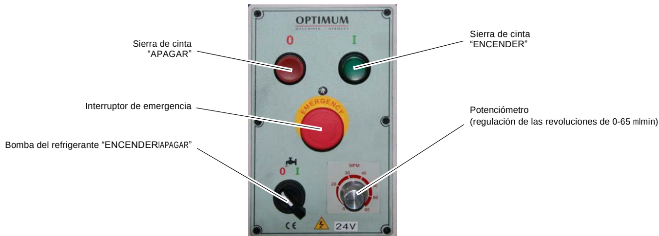
Fig.5-2: Panel de mando sierra de cinta para metal
