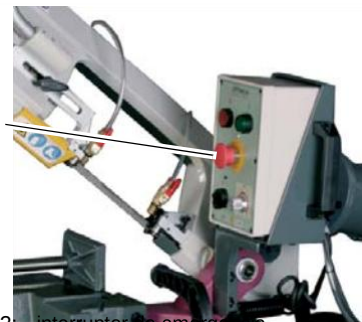
Fig.1-2: Interruptor de emergencia
