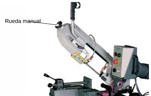
Fig. 4-4: Tensión de la cinta de la sierra
