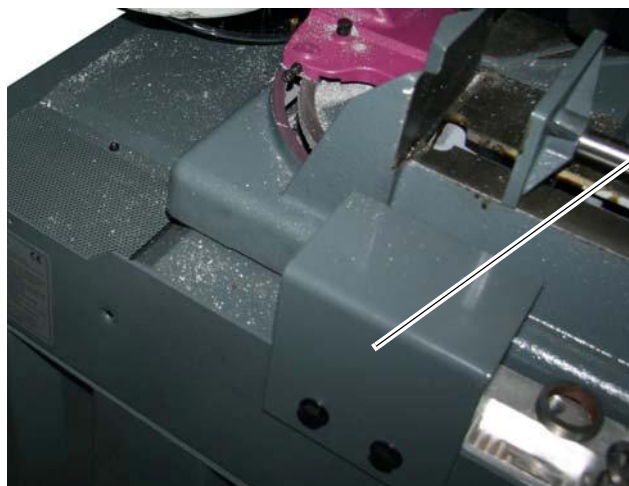
Fig.3-1: Montaje de la bandeja para el material
