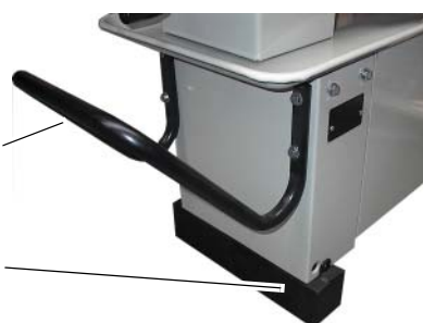
Imagen 3-2: Soporte de la máquina y asa de transporte
