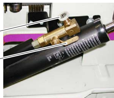
Img.4-11: Alimentación hidráulica
