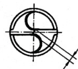
Longitud del filo del cinkel 10% de la broca - Ø
