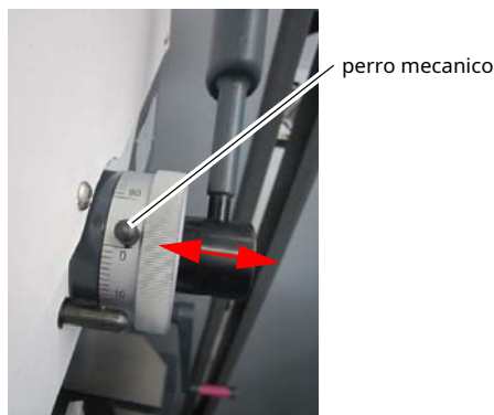
Imagen 4-3: Tope de profundidad de taladro mecánico
