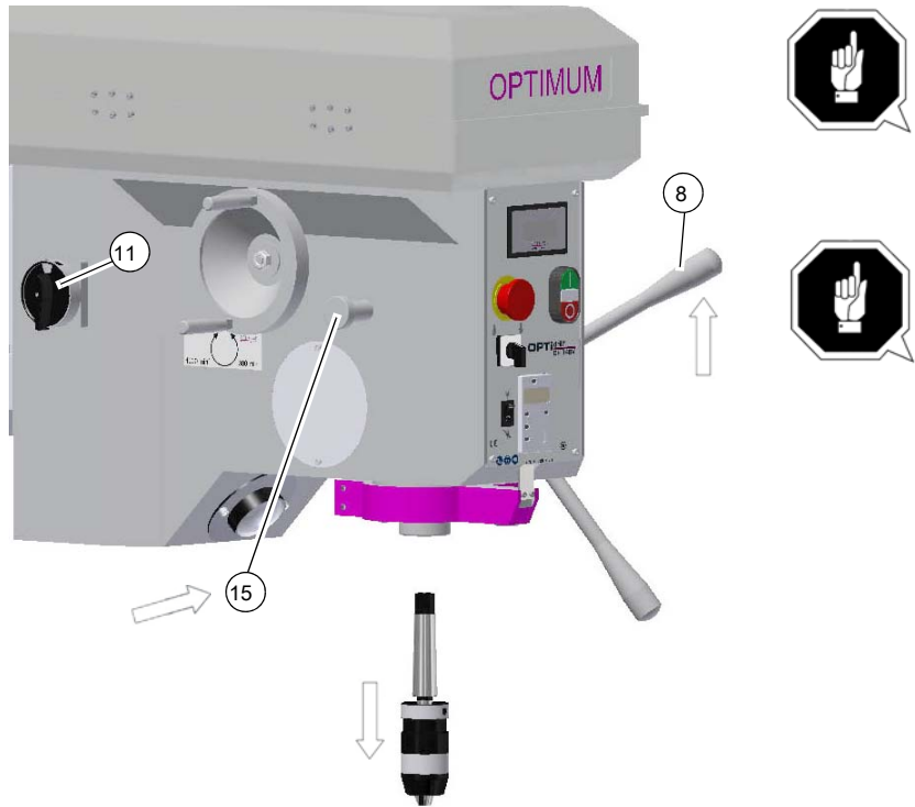
Img.4-11: Desmontaje con deriva de perforación integrada
