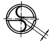
Longitud del filo del cincel 10% de la broca - Ø
