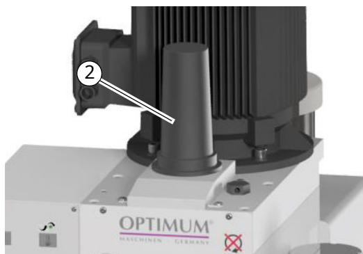
Img.1-2: cubierta protectora
