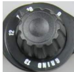
Fig. 4: Botón giratorio para nivel de protección
