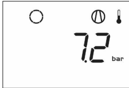
Pantalla principal con indicación de parada por alarma, temperatura de salida del elemento
