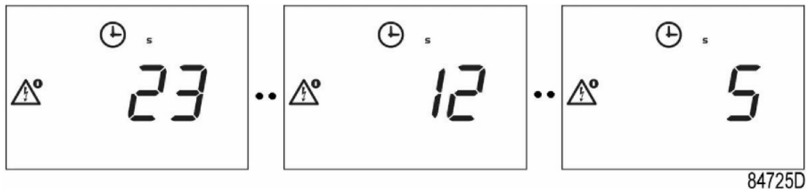
Ejemplo del tiempo de retardo de cuenta regresiva del reinicio automático después de una falla de voltaje.
