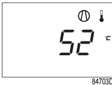
La pantalla principal con temperatura (compresor detenido)
