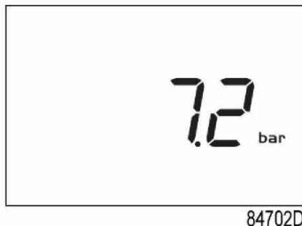
La pantalla principal con presión (compresor detenido)
