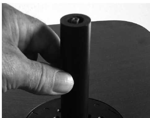
Fig. 7: Colocación del rodillo de lijado
