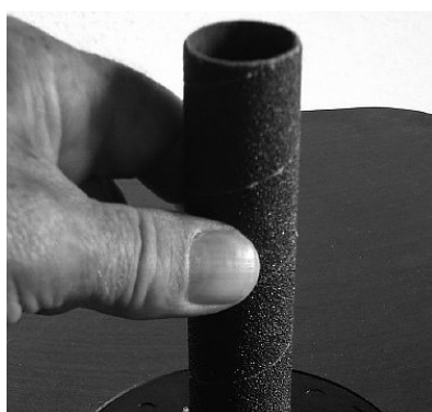
Fig. 8: Colocar el manguito de lijado en el rodillo de lijado
