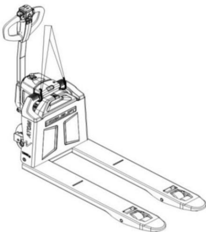
Figura 3-1: Transporte con grúa
