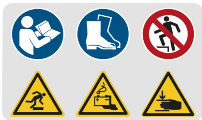
Figura 1-1: Señalización de seguridad y símbolos de advertencia: ¡Observe las instrucciones de funcionamiento! ¡Utilice calzado de seguridad! Señal de prohibición: Prohibido escalar. Símbolos de advertencia y peligro: Peligro de tropiezo, advertencia de peligro de baterías, advertencia de lesiones en las manos.
