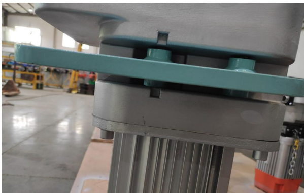
Fig. 10: Montaje de la placa de conexión
