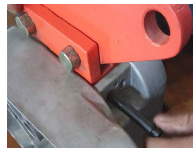
Fig. 7: Montaje de la placa de conexión
