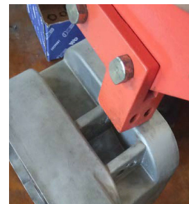
Fig. 6: Montaje de la placa de conexión
