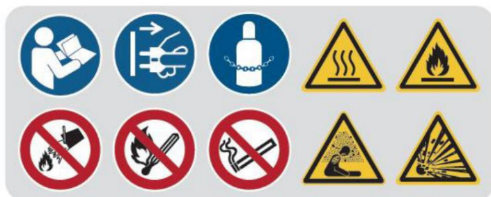
Figura 1-1: Señalización de seguridad - 1 Señal obligatoria: Observe las instrucciones de funcionamiento, desenchufe y asegure las bombonas de gas | 2 Señal de prohibición: Prohibido extinguir con agua, no usar llamas abiertas, fuego, fuentes de ignición abiertas y fumar | 3 Señal de advertencia: Advertencia de superficie caliente, advertencia de sustancias inflamables, advertencia de riesgo de asfixia, advertencia de sustancias explosivas
