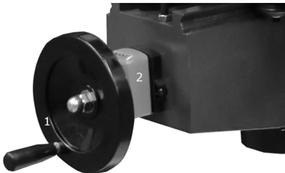
Fig. 5: Ajuste de la altura del husillo mediante el volante
