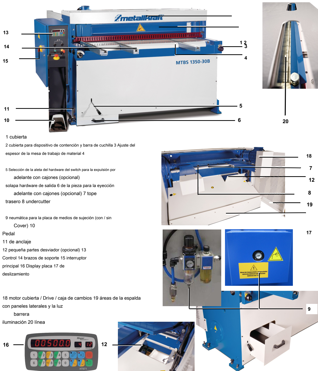
Fig. 6: Descripción de motor cizalla de guillotina
