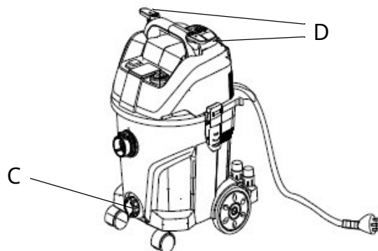
Fig.17: Toma adicional y función START / STOP automática
